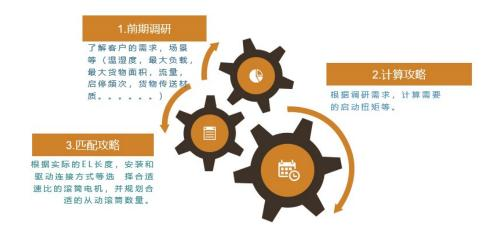
重点数据:传输材质,流量,启停频次,速度等。启动扭矩一般是额定扭矩的 2.5 倍关系。
